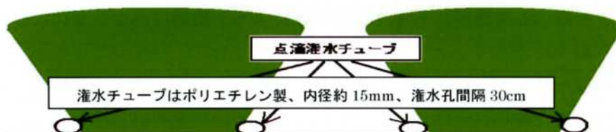
図2 液肥点滴灌水チューブの設置方法
