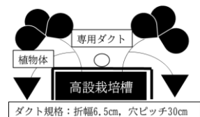
図 専用ダクト配置場所
