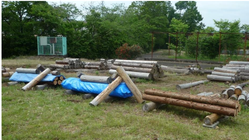
写真1 試験区 (左：上面被覆区 中央：全面被覆区 右：対照区)
