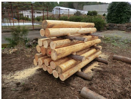
写真 1 剥皮あり・栈木ありの状態
