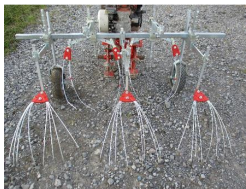
写真1 歩行型管理機装着型除草装置
