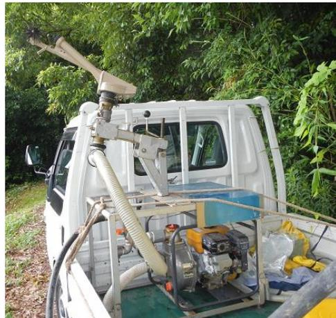
写真1 レインガン（ノズル部分）のトラック荷台への搭載状況
