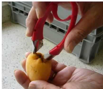
写真2 ヘタ取り器(下村工業株式会社製ピコ)による果頂部除去
