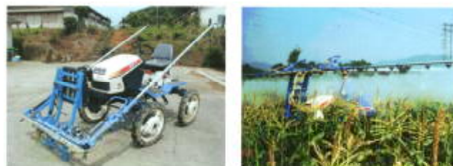
写真-6-16、6-17 愛知県で開発された高設ブーム
