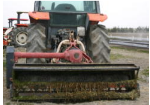
写真-6-21 トラクター装着型ハンマーナイフモア 表-6-18 スイートコーンの県慣行防除体系
