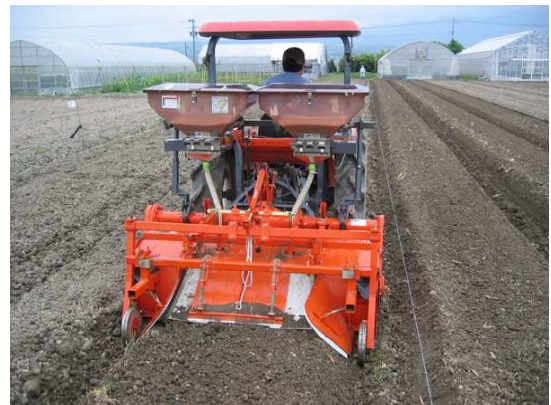
写真-5-49 畦内施肥機による施肥と畦成型の同時作業
