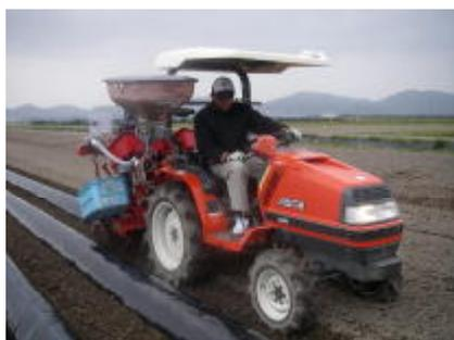
写真-5-22 多機能種いも植え付け機による作業状況
