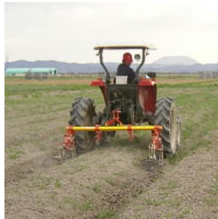
写真-4-53 トラクタに装着して畝間(通路)の除草作業
