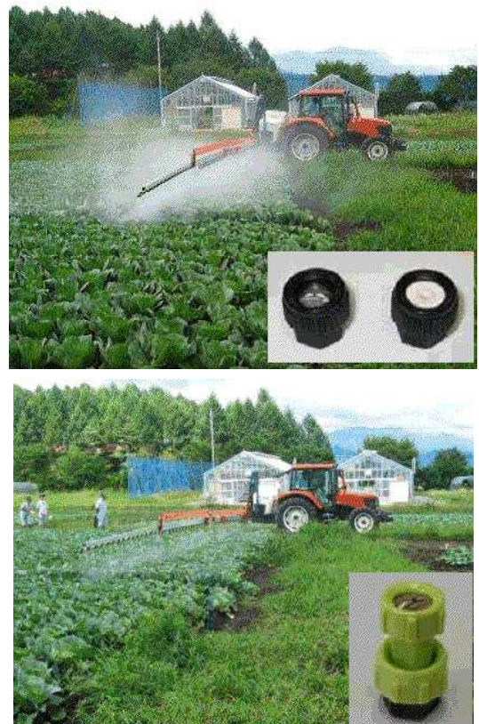
写真-4-51 ノズルによる防除時の薬剤拡散の様子 (上:通常ノズル、下:ドリフト低減ノズル)
