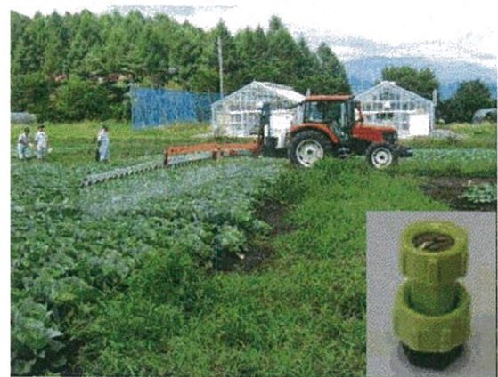
写真-4 ノズルによる防除時の薬剤拡散の様子 (上:通常ノズル、下:ドリフト低減ノズル)
