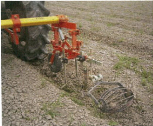
写真-5 除草機(カルチベータと後方に碎土輪を装着)
