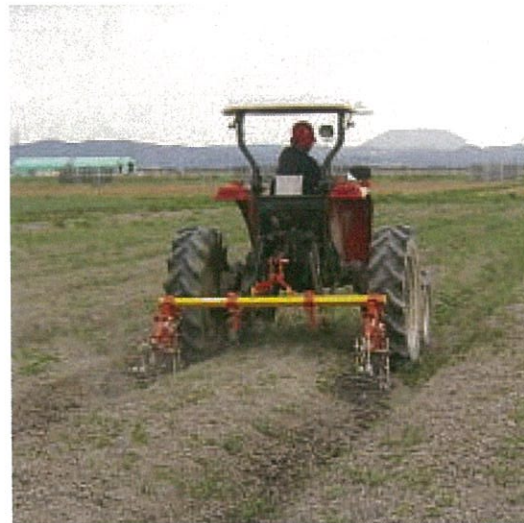
写真-6 トラクタに装着して畝間(通路)の除草作業
