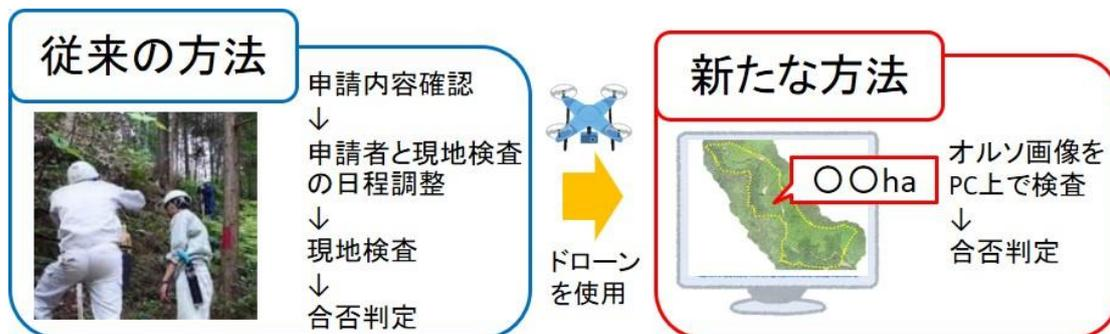
従来の検査方法とドローンによる新たな検査方法
