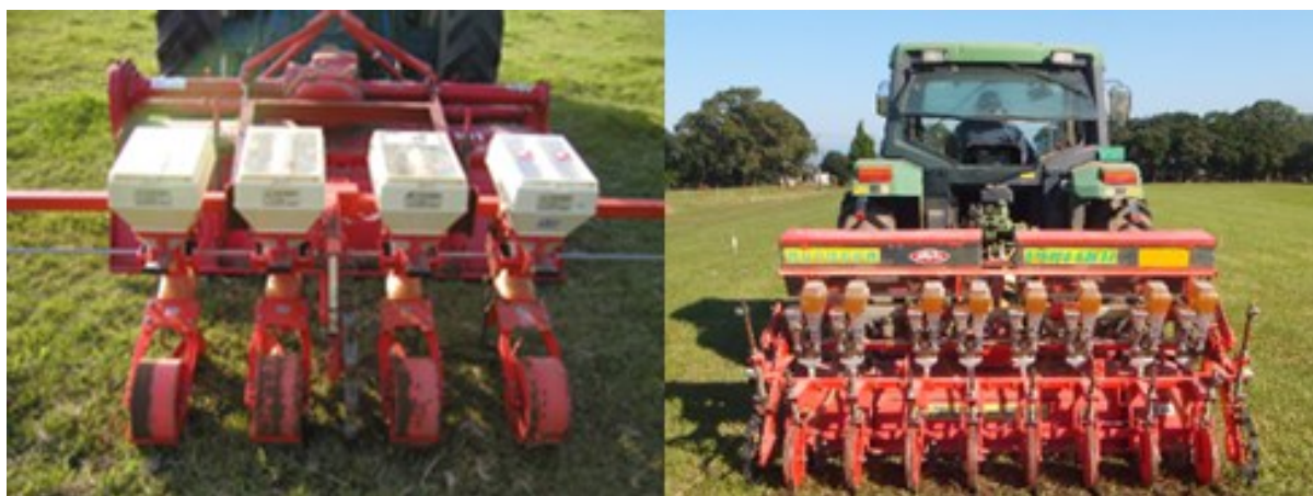
写真 51 リノベータ(右)と畜産研究部門が開発した改良型追播機(左)
