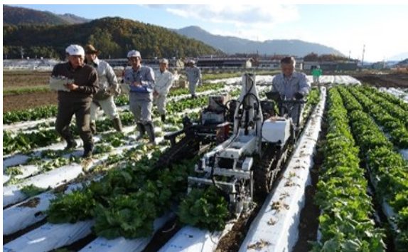
写真75 レタス自動収穫ロボット
