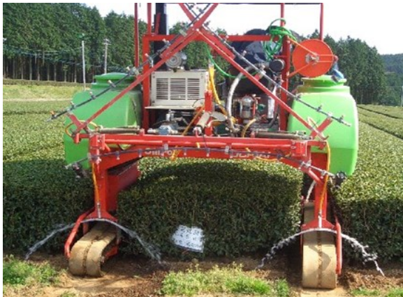
写真 44 乗用型管理機を用いた液肥散布
