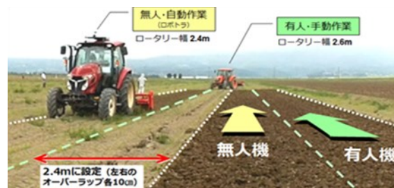
写真74 無人トラクターと有人トラクターによる協調作業
