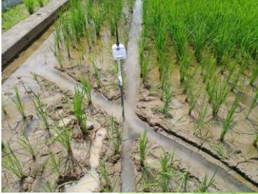
図3 水位センサー設置図
