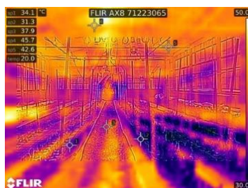
細霧冷房施用ハウスのサーマル画像
