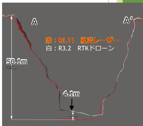
図4 ガリー最深部A-A'断面の土砂堆積
