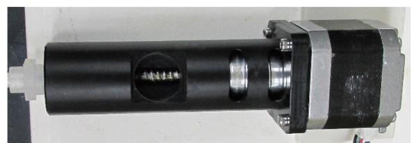
図 1 スクリー式の出装置
