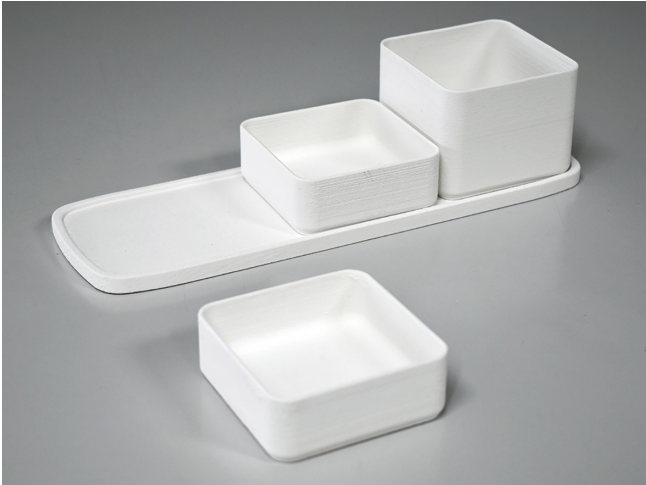
図1 3Dプリンタで試作したトレイと収納容器
