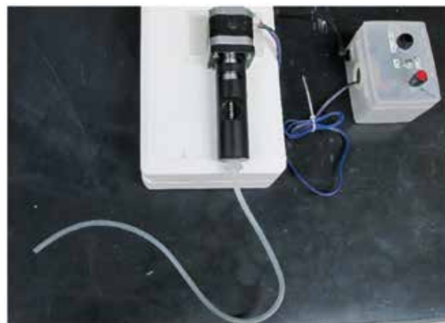
図 2 天草陶土の移送試験装置
