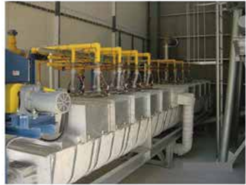
図2 遠赤外線パドルドライヤーの外観
