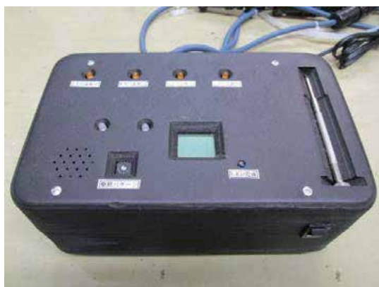
図1 光触媒モジュールの外観 上側: 紫外線部 下側: 電源部
