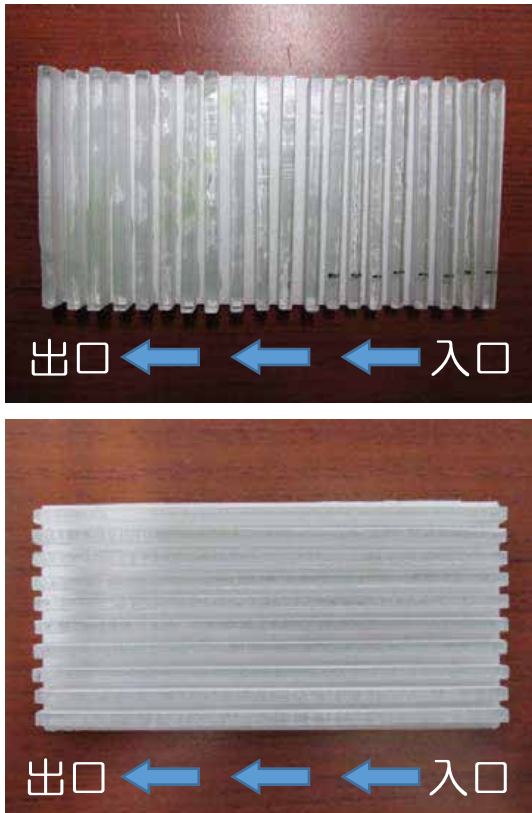
図3 循環水に対する成形体の設置方向 上側：垂直型 下側：平行型
