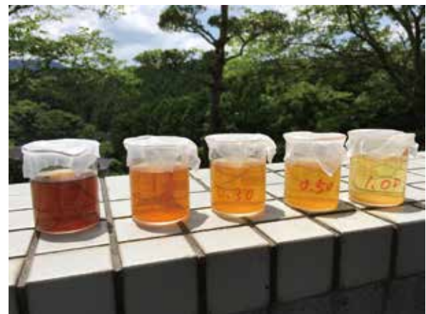
図4 脱水ろ液(前処理後) 左から、次亜塩素酸ナトリウム五水和物 0.05g、0.15g、0.30g、0.50g、1.00g 添加
