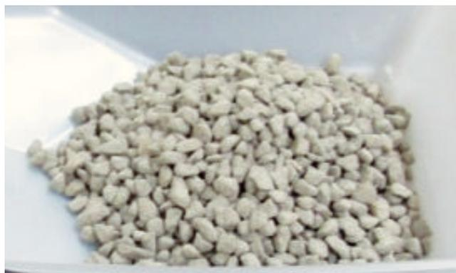
図4 作製した吸着材の外観
