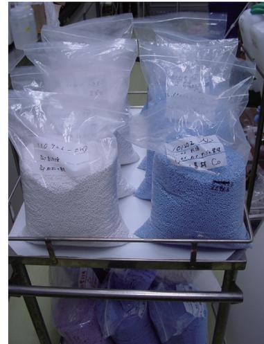
図3 合成したリン吸着材
