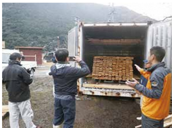
冷凍コンテナを活用した促進乾燥機
