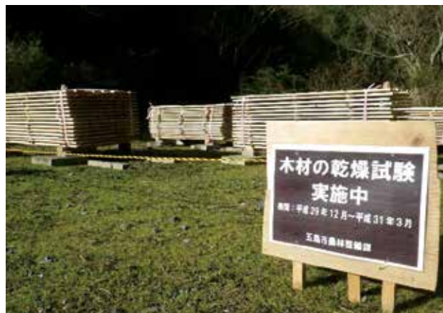
ふるさとの森林づくり事業 温泉水を利用した木材の乾燥試験（五島市）
