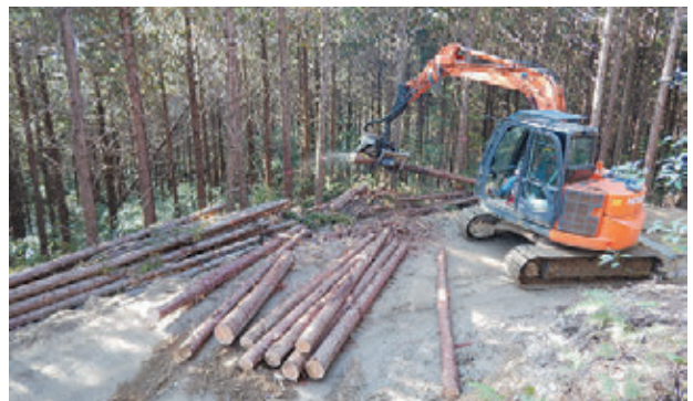
↑ 間伐した丸太を運び出すために重機で玉切 (県央振興局 林業課)
