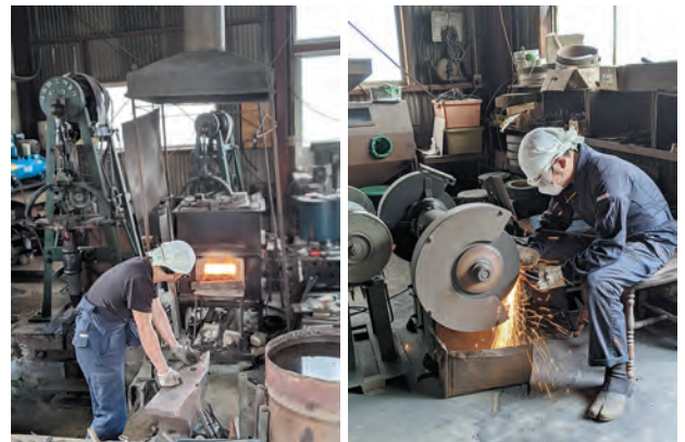
(左) 鍛造 高温の炉で鉄を鍛え上げる工程 (右) 成型 グラインダーで削る工程
