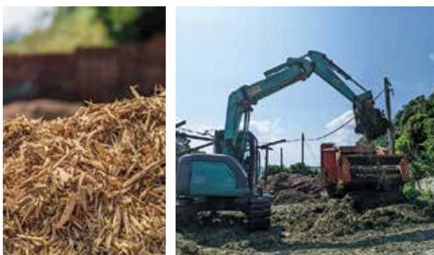
(左)伐採木や解体材を粉碎した木質チップ燃料 (右)枝葉や草、幹は粉碎機でバークに加工する ※バーク：樹皮をチップ状に加工したもの
