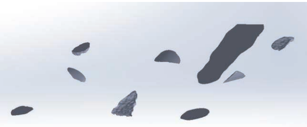
図7 破損部修復形状の3DCADデータ
