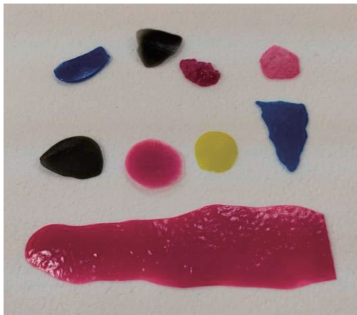
図12 3Dプリンタで出力した破損部修復形状の造形サンプル
