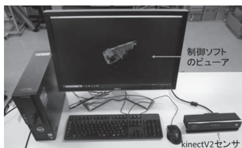
図1 試作した移動計測式自動モデリングシステム
