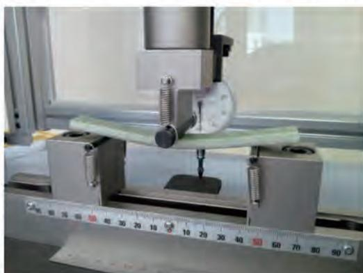
図1 3点曲げ試験実施状況
