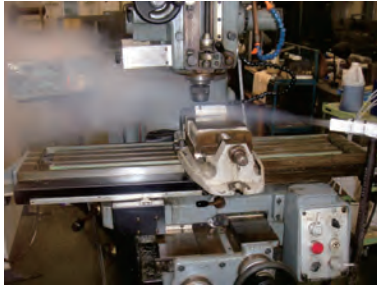
ドライアイスガス噴射による エンドミル切削加工実験
