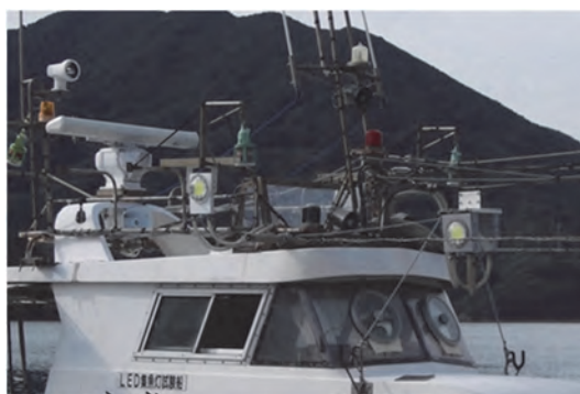
漁船に搭載した LED 集魚灯
