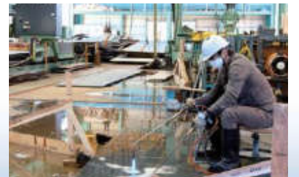
「ぎょう鉄」と呼ばれる造船業特有の厚鋼板を曲げる加工風景。先輩社員から技能が受け継がれている
