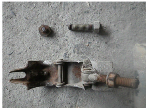
破断したブラケット部のボルト
