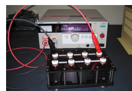
図3 絶縁抵抗試験器の始業点検
