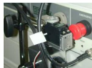
図3 押しボタンロボット機構
