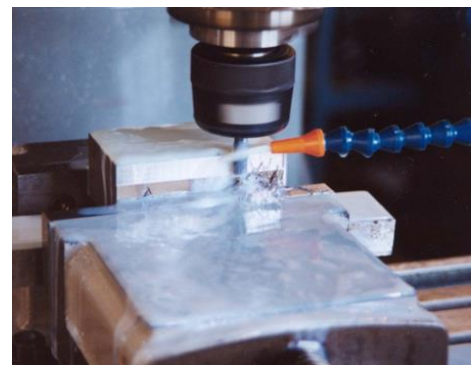
図1 切削油剤を用いたエンドミル切削加工
