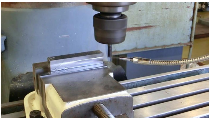
図2 水溶液ミストによるエンドミル切削加工
