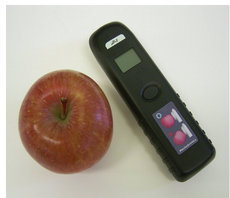
図2 TFDRS法をベースとした携帯型糖度計。光源に発光ダイオードを使用し、重量190g(電池重量含む)と世界最軽量を実現。
