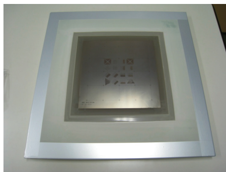
図2 DLC 膜をコーティングしたスクリーンマスク
