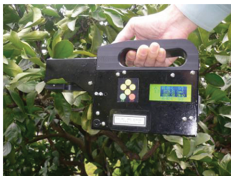
図1 分光式水分ストレス計（試作開発機）
