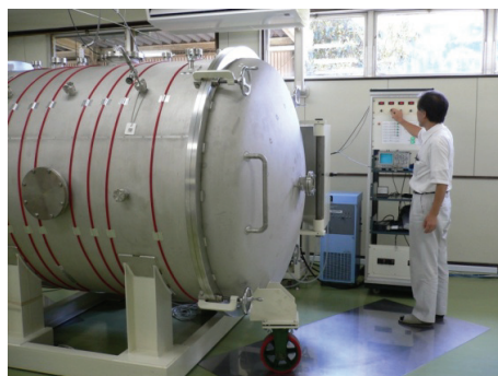
図1 ファインコーティング(株)に設置された大型 PSII 装置
