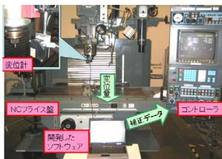
図1 高精度化システム
