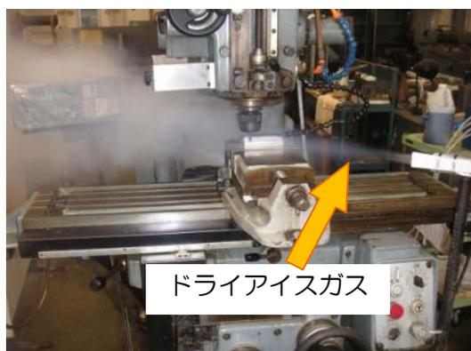
図2 ドライアイスガス噴霧によるエンドミル切削加工
