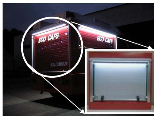
図1 LED埋め込みアルミバーシャッター
