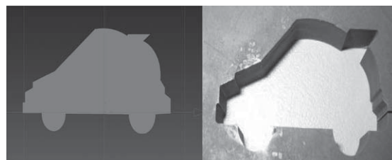
図 1 7 ワイヤ放電加工機の加工結果
