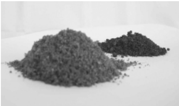
図1 部分的に液化した木材の性状 (Phenol/Wood=1/1, Temp. =175°C (左前) 225°C (右奥))
