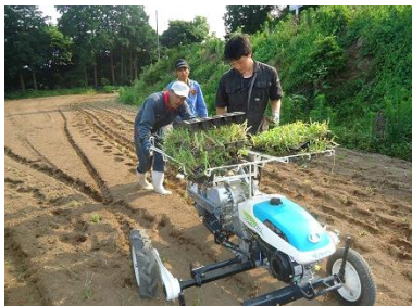
野菜移植機を用いて苗移植
