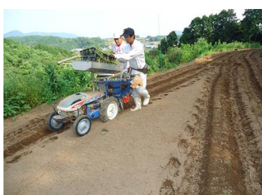
馬鈴薯移植機を用いて苗移植
